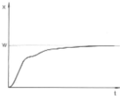
Fig. 56: Parametri di regolazione  $T_n$  e  $T_v$  troppo grandi
