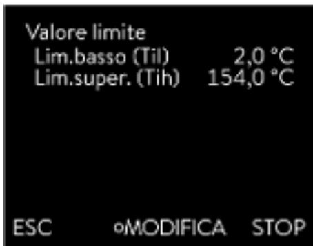
Fig. 39: Definizione dei valori limite di temperatura
